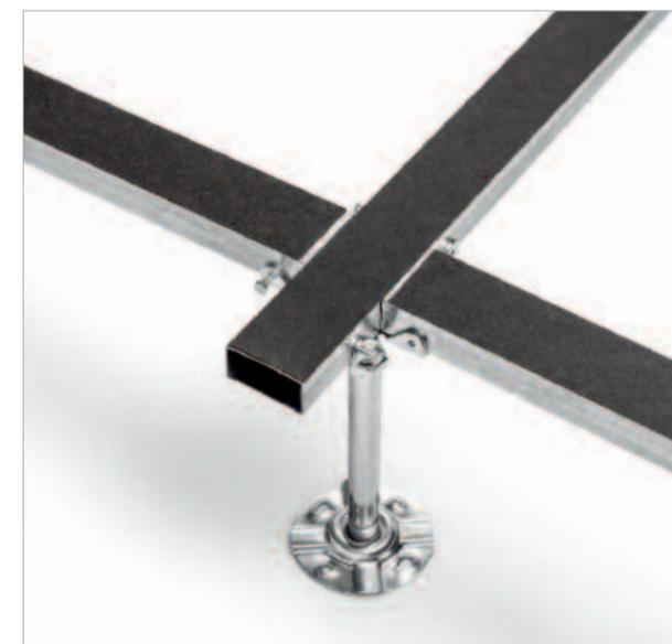
I traversini scatolati tipo P in acciaio zincato a sezione chiusa 50x25 mm, spessore 10/10 mm, sono di due dimensioni, 550 e 1800 mm, e sono dotati di guarnizione adesiva antirombo.
